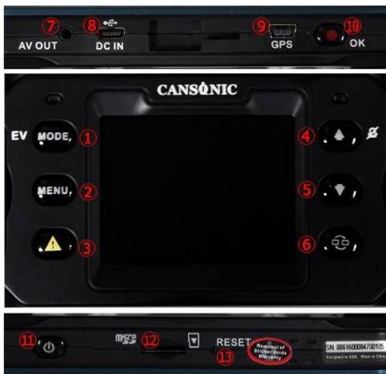
\* 赤い矢印のマークがビデオカメラのマークの時は動画撮影モードです。この部分がPというマークの時はMODEボタン(①)を数回押してビデオカメラのマークにして下さい。
