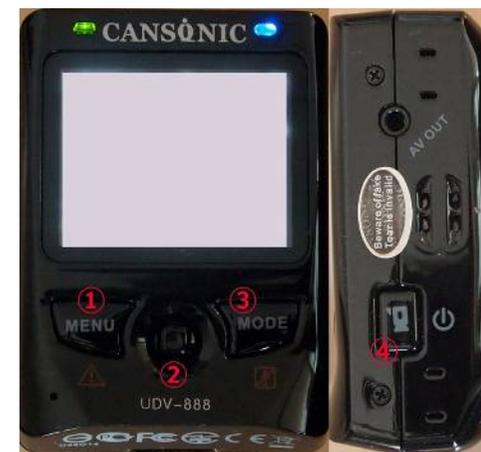
\* DC INより電源が供給されている場合は自動で録画が始まりますので1度録画/電源ボタン(④)を押し録画を止め再度録画を始めて下さい。
