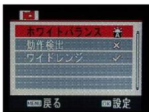
真ん中のスティックスイッチ(②)を下側に押していくと左記の画面になります。動作検出を選択して頂きオフに設定してください。
